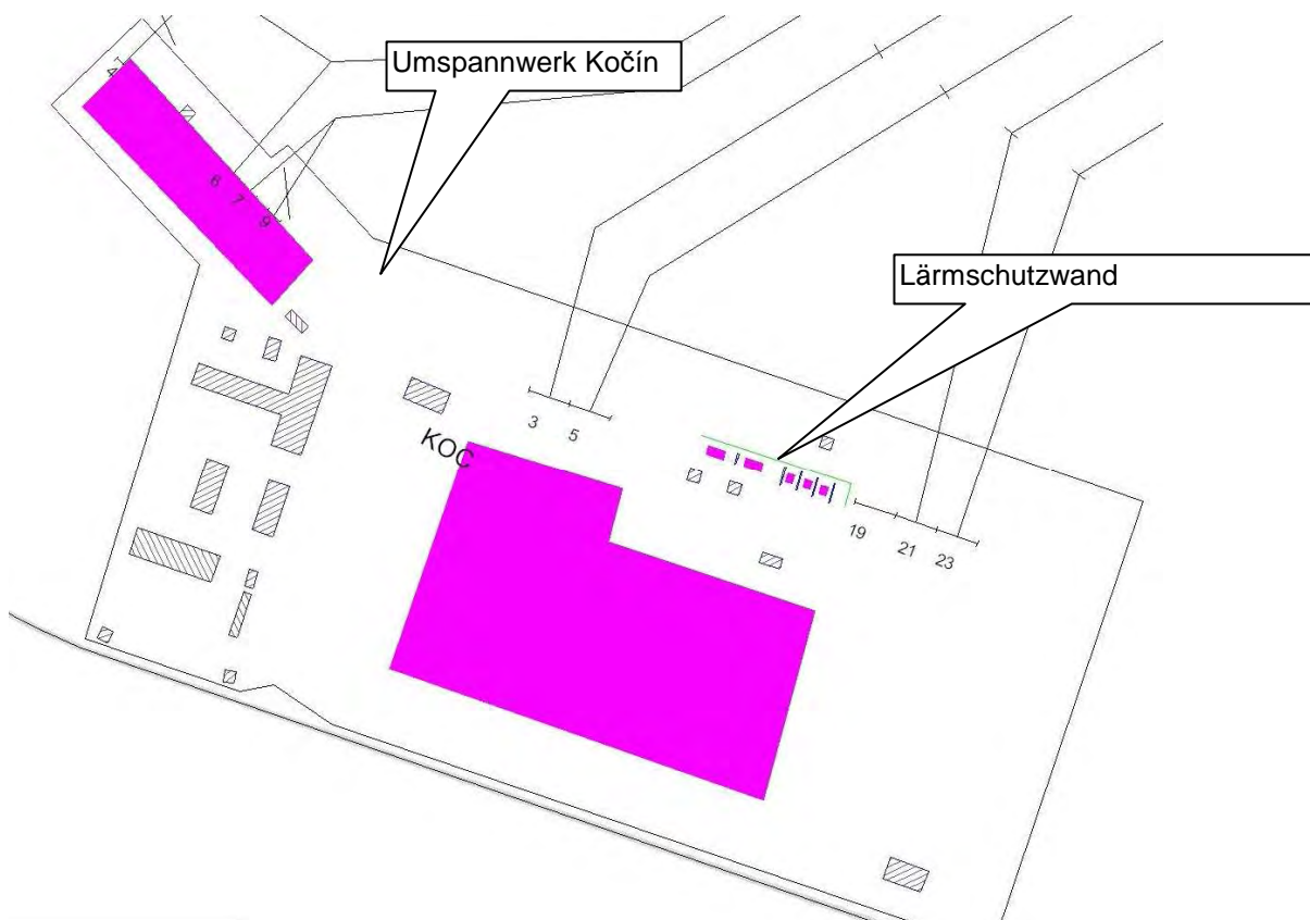
Bild 6.1.2 Position der Lärmschutzmauer im Umkreis der Transformatoren des Umspannwerks Kočín
